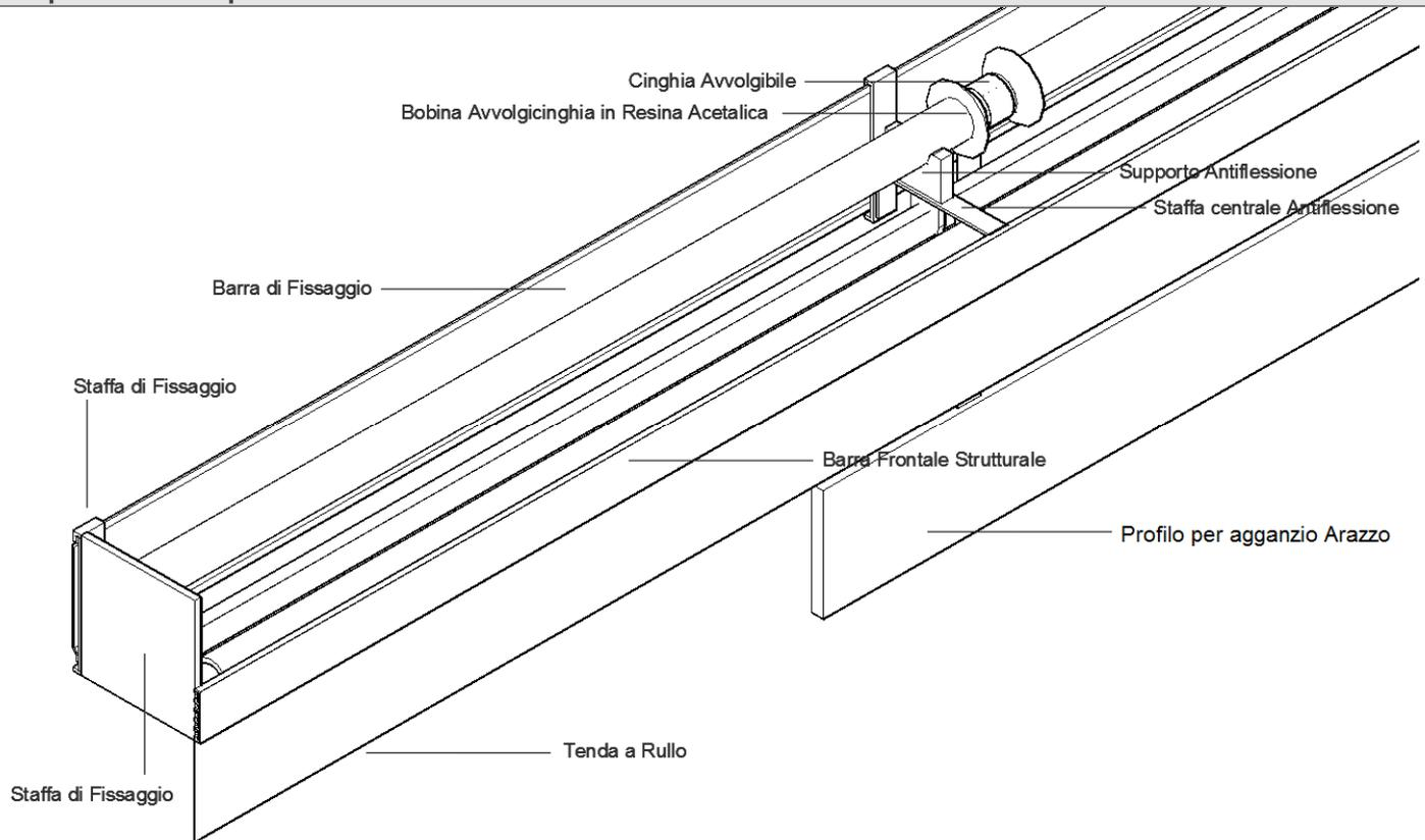
**Supporti:** Barra di installazione in acciaio della stessa lunghezza del sistema che permette una distribuzione del peso armonica.
