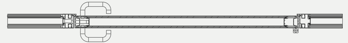
Sezione orizzontale della porta battente doppio vetro. /Horizontal section of hinged double glass door.
